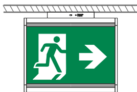
Τοποθέτηση σε οροφή
