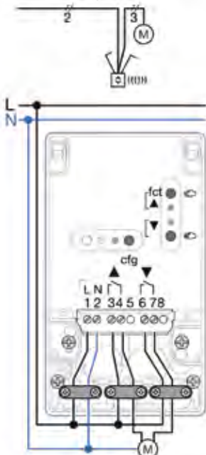
Εικόνα 1: Συνδεσμολογία ελέγχου μοτέρ ρολών
