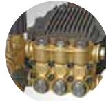
Τριεμβολική αντλία με ορειχάλκινη κεφαλή και ταχυσύνδεσμο
