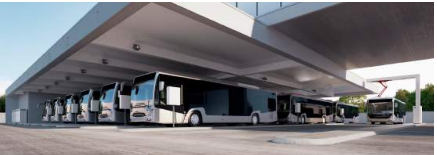
Σύστημα 150 kW με 3 φορτιστές για 3 οχήματα διαδοχικής φόρτισης
